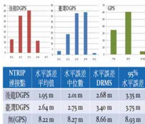
圖 3.22 NTRIP 網路 DGPS 各站與 GPS 定位誤差比較
