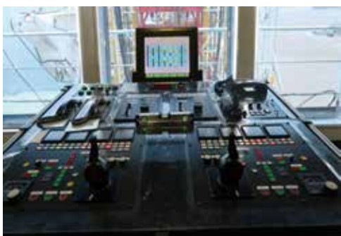
動力定位系統 (DP) 操作台，真正作業的時候這個位子係屬於DP0 6 操作師的，讓船可以抵抗海流不偏移。
