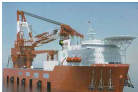
這是一艘起重鋪管船，除了船艙配備了左右三個艙錨外，船艙也配有左右兩個艙錨，號稱十錨定位系統。
