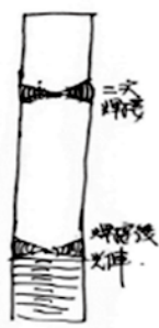
圖8主機牽柱螺栓底部螺紋處二次再焊接
