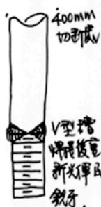
圖7主機牽柱螺栓底部螺紋處切斷再焊接
