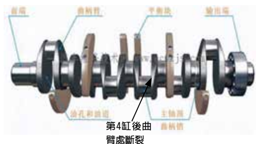
圖3 發電機曲軸(Crankshaft)第4缸後曲臂處斷裂
