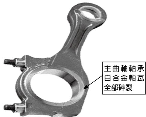
圖10柴油機連桿，下端大圓為主曲軸軸承
