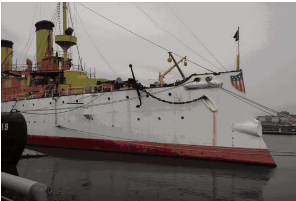
圖十、1893年造的美國巡洋艦奧林匹亞號 (USS Olympia) 還用有桿錨，必須用吊桿吊起放在甲板上。圖中黑色的錨臂與錨幹平放在特製的錨床上，垂直的錨桿只好伸出船邊，船首甲板上兩支交叉的黃色吊桿，就是專為拋錨、起錨用的。(2009年趙榆生攝於美國費城)
