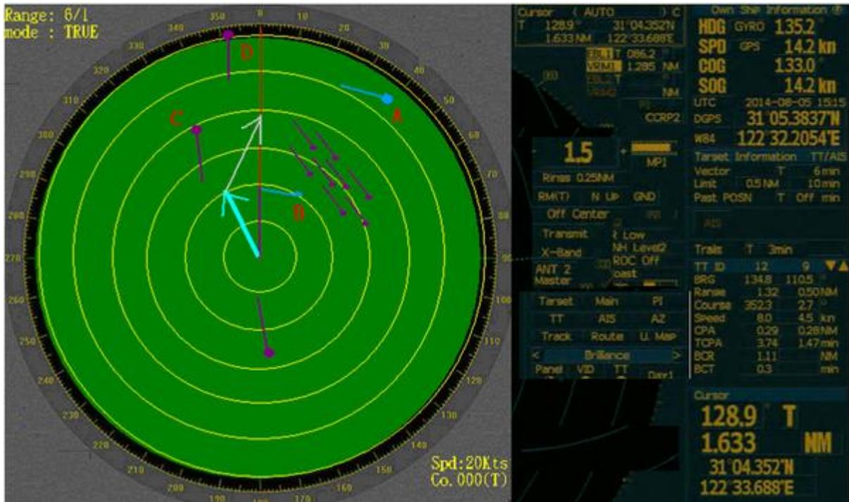
ARPA 並不能夠提供，我們瞭望當值，所需要的每一件資料，而且還經常會失去目標的回跡，就像雷達一樣。即使所有的目標都能被探測到，但是最具挑戰性的部分，還是在如何能夠正確的確認目標？大小船分不清，這種情形，最經常在夜間發生，見上圖，當一條遠洋船隻(淡藍色 A 船)在漁船群附近航行。而其中的一條漁船(淡藍色 B 船)，可能提早脫隊，並且與其他船隻的航向不同。由於目標太多，漁船也沒有標準的航行燈顯示，當值船副無法在目視中確認，是哪一條漁船脫隊？(船副不具備，目測 B 船距離的能力，也不具備目測 B 船方位的能力)在這種情況下，當值船副的處置，很可能就是放棄目視的觀察，然後專心在 ARPA 顯示幕上的操作，觀測 B 船在 ARPA 上的動向。同樣的情形，船副也可能無法分辨，A 船航行燈與其他漁船的部位燈光，只好專心在 ARPA 的顯示幕上。
